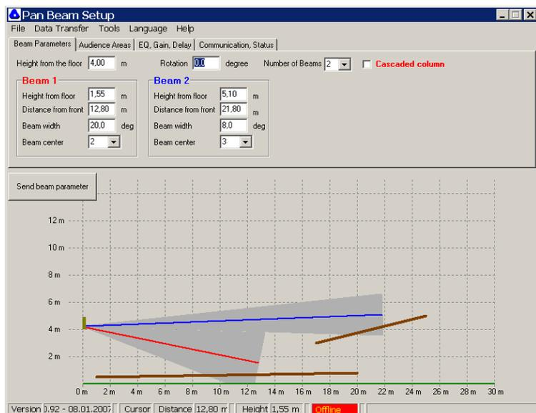
Facile d'emploi, le logiciel de contrôle **PanBeam®** (angle de focalisation, angle d'élévation, centre acoustique, égaliseur, volume, et délai) permet la mise en place du réseau, ainsi que la surveillance de tous les composants du système.
